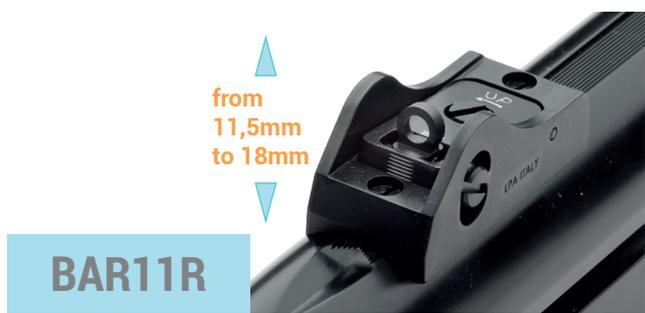
■ Tacca di mira per fucili totalmente regolabile tramite solide viti a click per mezzo di una moneta di qualsiasi dimensione. Progettato per usi estremi, la tacca è dotata di due ali d'acciaio che proteggono la diottra intercambiabile. Il BAR11R si fissa facilmente sui più comuni fucili per la difesa personale e militari. Fornito con diottra \*\*D4 standard (o \*\*D2, \*\*D3, \*\*D5, \*\*D7 a richiesta). E' necessario fresare, forare e filettare per poterlo fissare.
